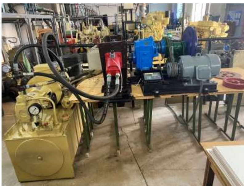
Рисунок 4 – Экспериментальный стенд (общий вид) используемый для проведения исследования гидропривода, чувствительного к изменению нагружения
