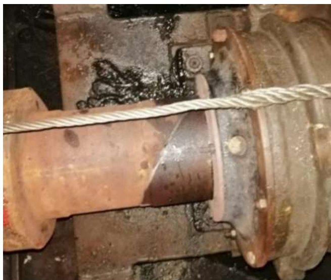
Рисунок 2 – Излом промежуточного вала морского судна
