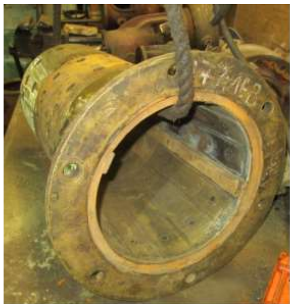
а) дейдвудный подшипник с вкладышами из капролона
