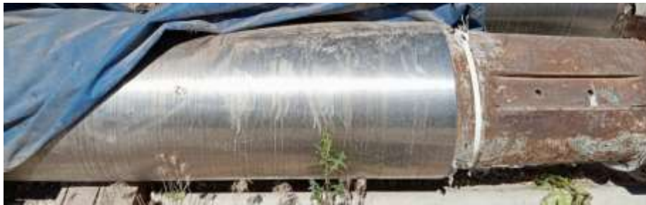
Рисунок 1 – Общий вид облицовочной втулки гребного вала ледокола
