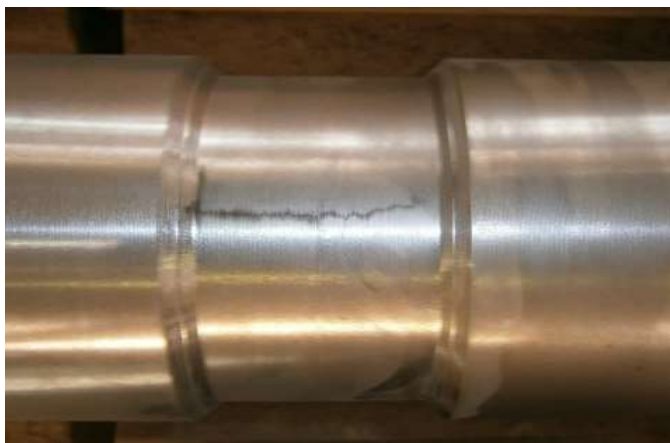
а) продольная трещина в районе шейки гребного вала
