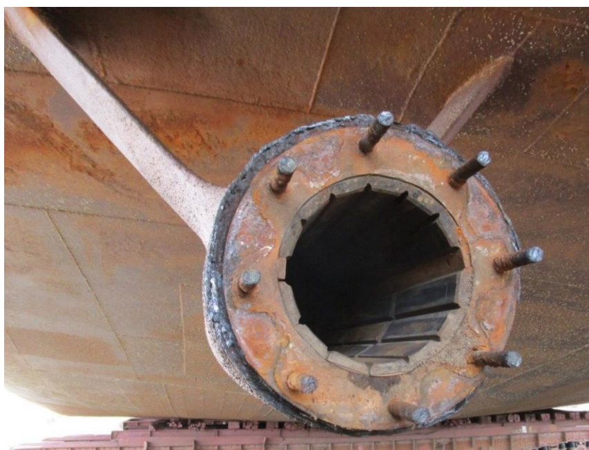
Рисунок 3 – Общий вид расположения дейдвудного подшипника
