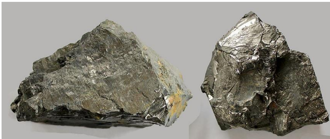
Рисунок 5 – Антрацит, типовое топливо для лабиринтного котла
